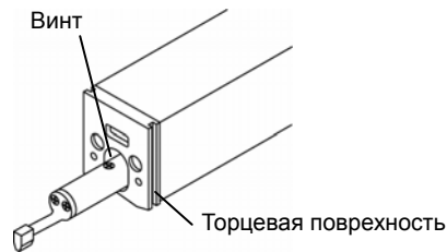
Вид после установки датчика
