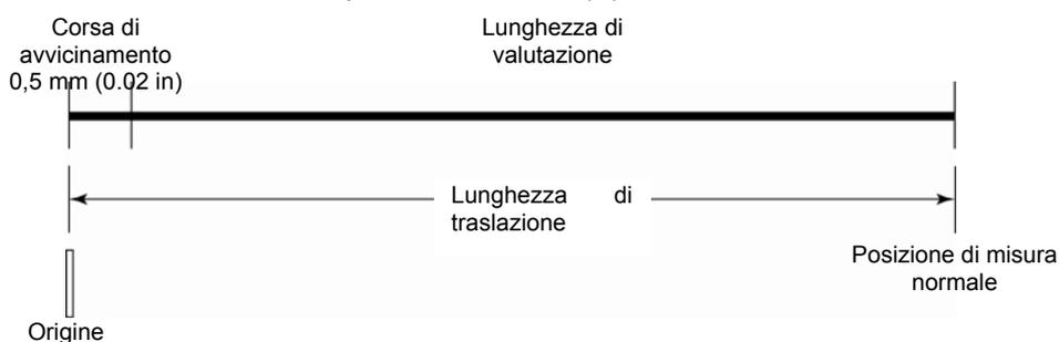
Lunghezza di traslazione (misurazione con profilo non filtrato (P))
