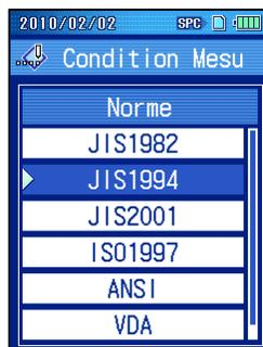
2 Sélectionner une norme de rugosité compatible avec la surface cible au moyen des flèches [↑] [↓], et presser la touche [Enter/Menu].
