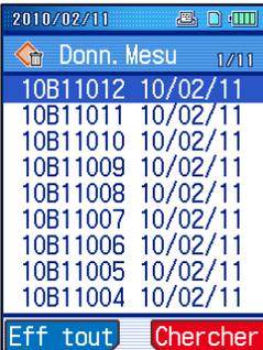
**3** Sélectionner les résultats de mesure à supprimer avec les flèches [ ↑ ] [ ↓ ], et presser la touche [Enter/Menu].
