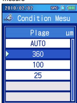
2 Sélectionner une plage de mesure compatible avec la surface cible au moyen des flèches [↑] [↓], et presser la touche [Enter/Menu].
