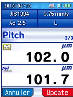
**5** Trois mesures doivent être effectuées, de 0,25mm/s à 0,75 mm/s (de 0.010 in/s à 0.030 in/s).
