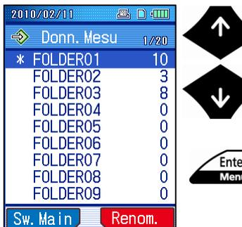
2 Sélectionner le dossier dans lequel les résultats de mesure sont enregistrés en utilisant les flèches [ ↑ ] [ ↓ ], et en pressant la touche [Enter/Menu].
