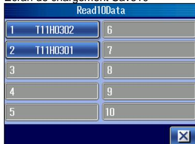
2 Sélectionnez les résultats de mesure à charger en appuyant sur le bouton correspondant.
