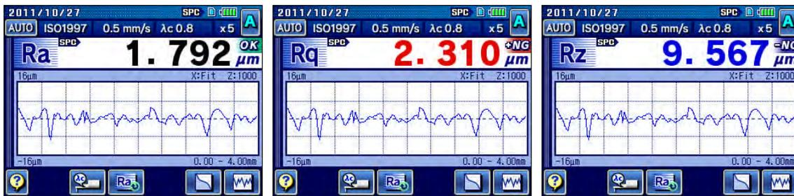
Résultat d'évaluation OK/H.T. (à l'intérieur des limites, au-dessus de la limite supérieure, en dessous de la limite inférieure)
