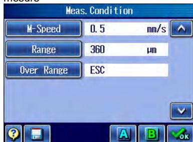
➤ La plage de mesure sélectionnée apparaît sur l'écran du menu des conditions de mesure.
