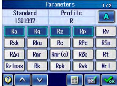
**1** Vérifiez que la norme de rugosité et le profil d'évaluation sélectionnés conviennent aux paramètres à personnaliser.
