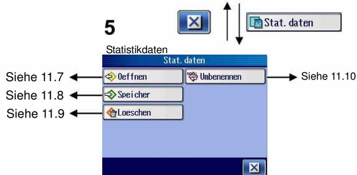
**TIPP** • Der Ausdruck der eingestellten Druckobjekte erfolgt, wenn bei Anzeige der Statistik-Ergebnisse die Taste
