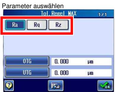
3 Stellen Sie ein, für welche Parameter die Toleranzbewertung durchgeführt werden soll.
