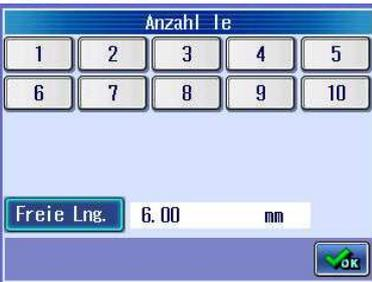
➤ Die eingestellte Auswertlänge wird jetzt neben der Schaltfläche “Freie Lng.” angezeigt.
