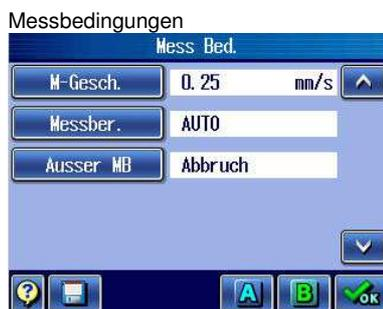
➤ Die eingestellte Messgeschwindigkeit wird jetzt im Fenster Messbedingungen angezeigt.
