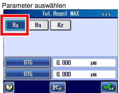
➢ Die Parameter-Schaltfläche wird jetzt in blau angezeigt.
