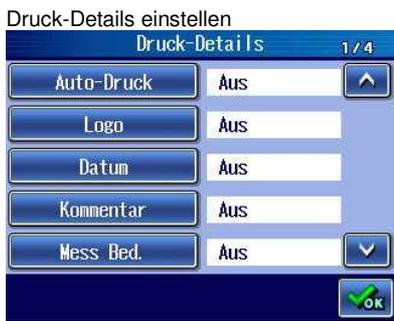
2 Bei aktivierter Auto-Druck-Funktion wird das Messergebnis nach jeder Messung automatisch ausgedruckt.
