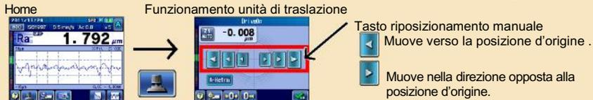
(3) Se il range di misura del detector non viene ottenuto, eseguire nuovamente le operazioni da (1).
