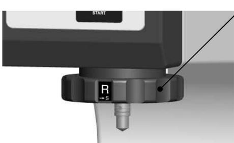
Méthode d'essai de dureté Rockwell
