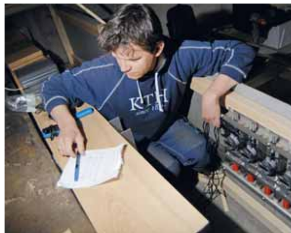
Magnus Burman på KTH monterar provbitar för mätning. Maskinfjädrarna (de klarröda) ser till att belastningen på provbitarna är konstant och Mitutoyos fem mätare registrerar krypdeformationen.
