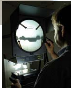
I mätprojektorer syns tydligt om en profil avviker från mallen.
