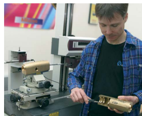
– Förr var vi tvungna att klyva blandarhusen i två delar för att kunna mäta de invändiga gjutnivåerna, berättar Kenneth Lindkvist.
